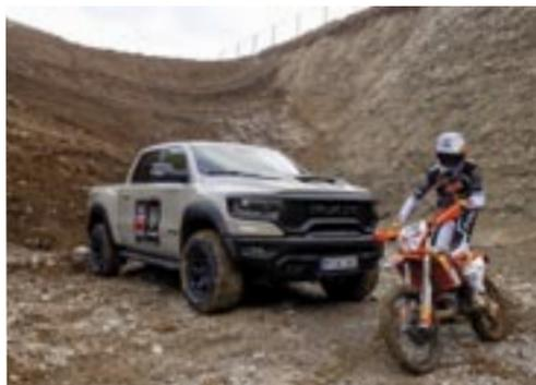
vier RAM 1500 zur Verfügung gestellt. Bei den beiden stärksten Modellen stellt der kompressorgeladene 6,2-Liter-V8-Motor über 700 PS zur Verfügung. Der RAM 1500 TRX kann bis zu 81 Zentimeter tiefes Wasser durchqueren, bis zu 3.674 Kilogramm ziehen und eine Nutzlast von bis zu 594 Kilogramm transportieren.
